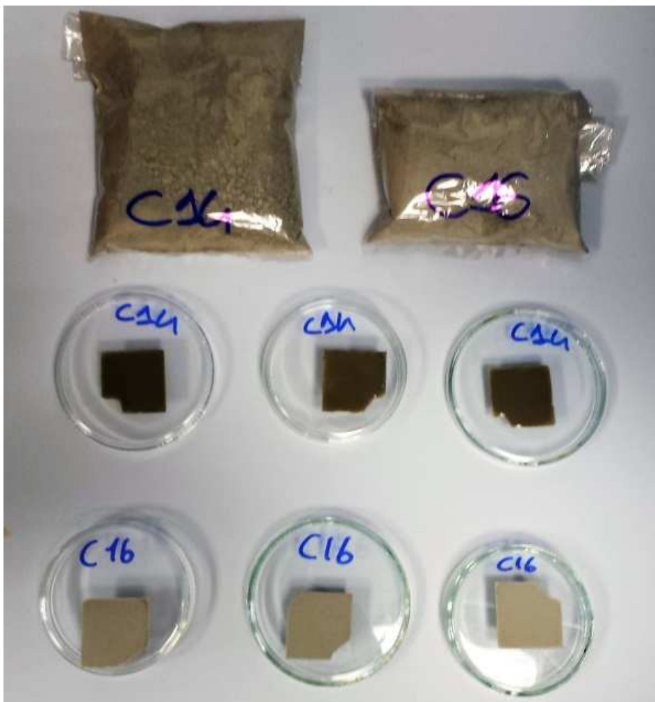
Fig. 22: 6 vetrini copri oggetto con i campioni C14 e C16 dispersi ad umido.
